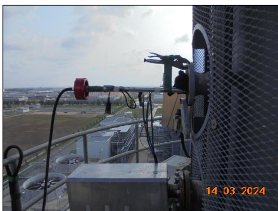
รูปที่ 3.2 การเก็บตัวอย่างคุณภาพอากาศในปล่องระบาย บริเวณ ปล่องหน่วยผลิตไอน้ำ HRSG 42
