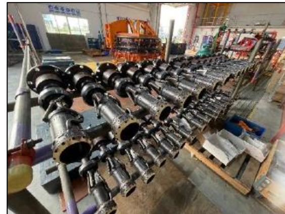
รูปที่ 2.2 อุปกรณ์ Burner ในระบบหัวฉีดเผาไหม้ แบบ Dry Low NO x
